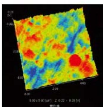
电位像 5μm×5μm 可知有CNT存在的部位电位低
